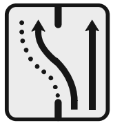
TS-61 Desvío de un carril por la calzada opuesta, manteniendo otro por la de obras
